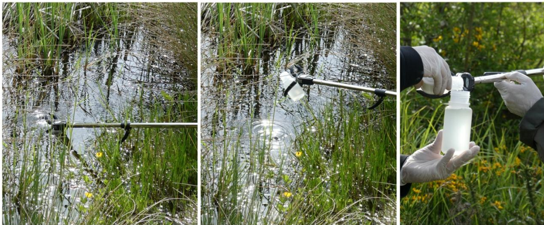
Figura2. Recolección de las muestras de agua en el campo: a) y b) recolección de las submuestras de agua con el bote auto-clavado de 50 mL mediante las pinzas telescópicas; c) trasvase de las submuestras al bote auto-clavado de 250 mL.
