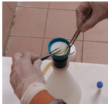
Figura 4. Retirada del filtro de celulosa del embudo Nalgene™ mediante pinzas esterilizadas al fuego.
