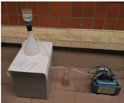
Figura 3. Montaje de filtrado con la bomba de vacío eléctrica y el embudo Nalgene™ emplazado en el kitasato mediante un tapón de caucho con un orificio interno de 11 mm.
